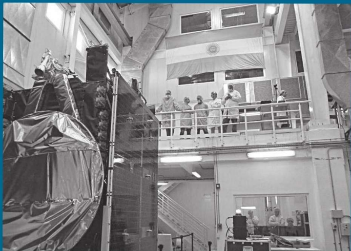
Paneles solares que forman parte del satélite geoestacionario argentino ARSAT 1 en el laboratorio durante la etapa de pruebas.
