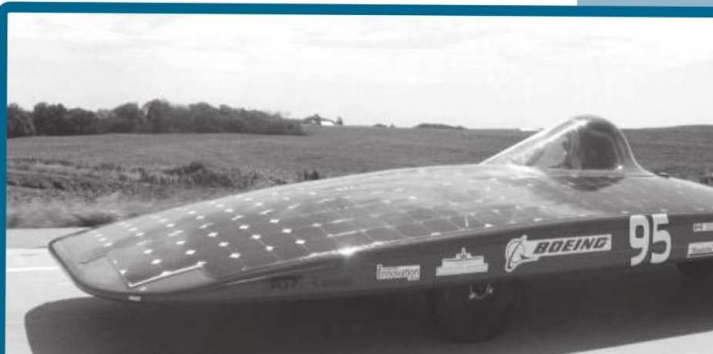
Automóvil solar eléctrico alimentado por una serie de pequeñas células solares ubicadas en la superficie superior del vehículo.
